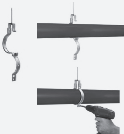
Instalación de los soportes:
